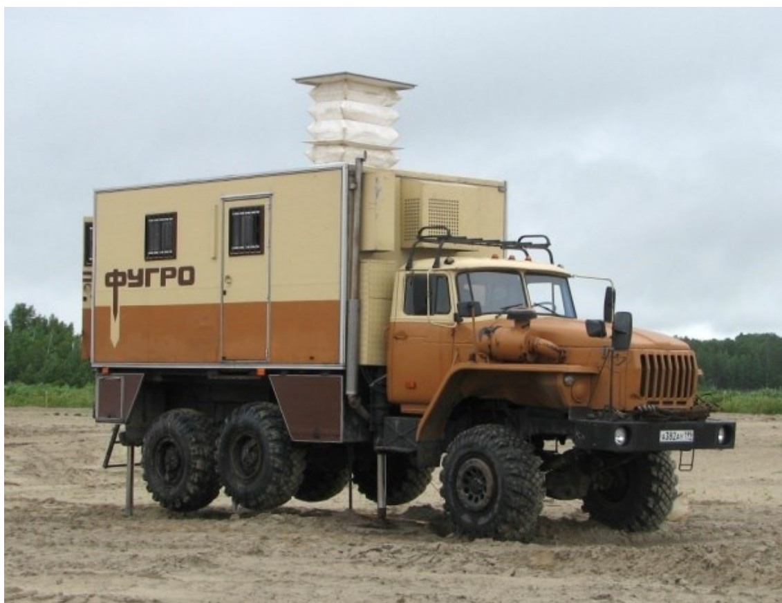
Рис.35. Установка статического зондирования.
