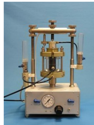
Рис. 67. Стабилометр конструкции ООО «НПП «Геотек», а – конструкция рабочей камеры и схема нагружения образца грунта; б – общий вид прибора
