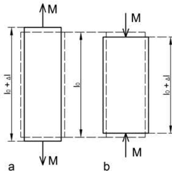
Рис. 2.4.4. Возникновение упругих сил в стержнях
