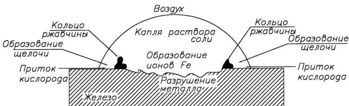
Рис. 4. Коррозия железа в условиях неравномерной аэрации
