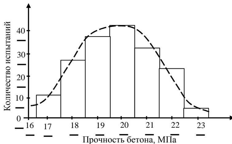
Рис. 12.5. Гистограмма прочности бетона
