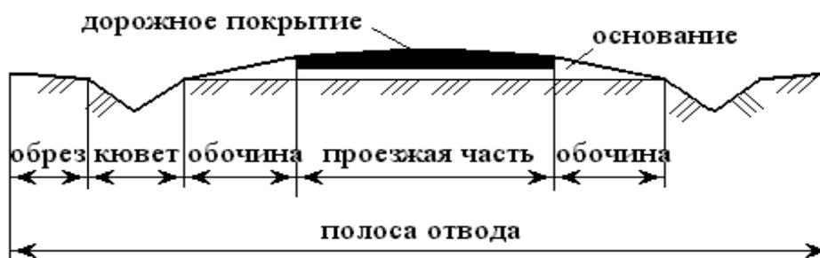
Рис. 36 Устройство дороги
