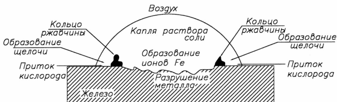
Рис. 4. Коррозия железа в условиях неравномерной аэрации
