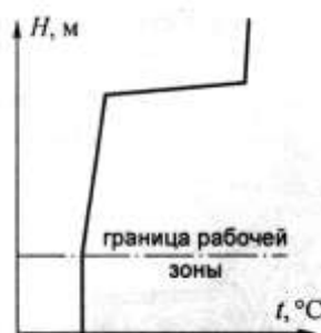
Рис. 4.2. Распределение температуры воздуха по высоте помещения с естественным расслоением воздуха в виде «температурного перекрытия» или «тепловой подушки».
