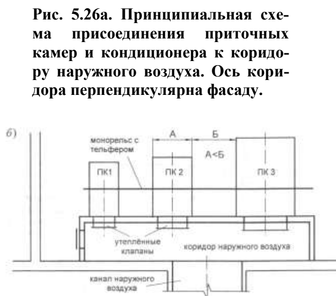
Рис. 5.26 а. Принципиальная схема присоединения приточных камер и кондиционера к коридору наружного воздуха. Ось коридора перпендикулярна фасаду.
