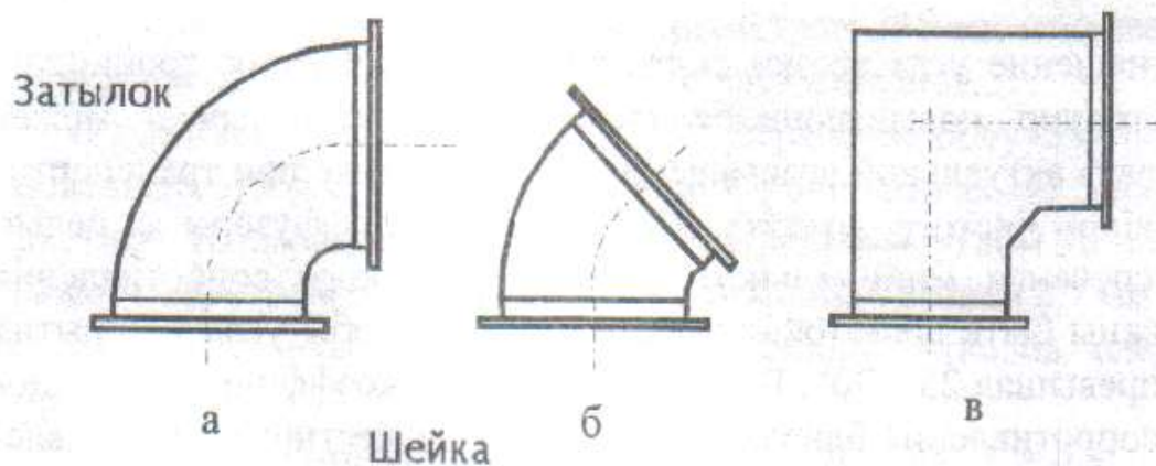
Рис. 15. Отводы прямоугольного сечения: а и б – отводы 90 и 45°; в – колено 90°
