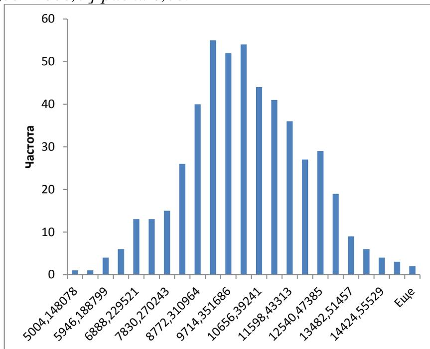
Рис. 2.6. Распределение значений интенсивности движения (гистограмма частот)
