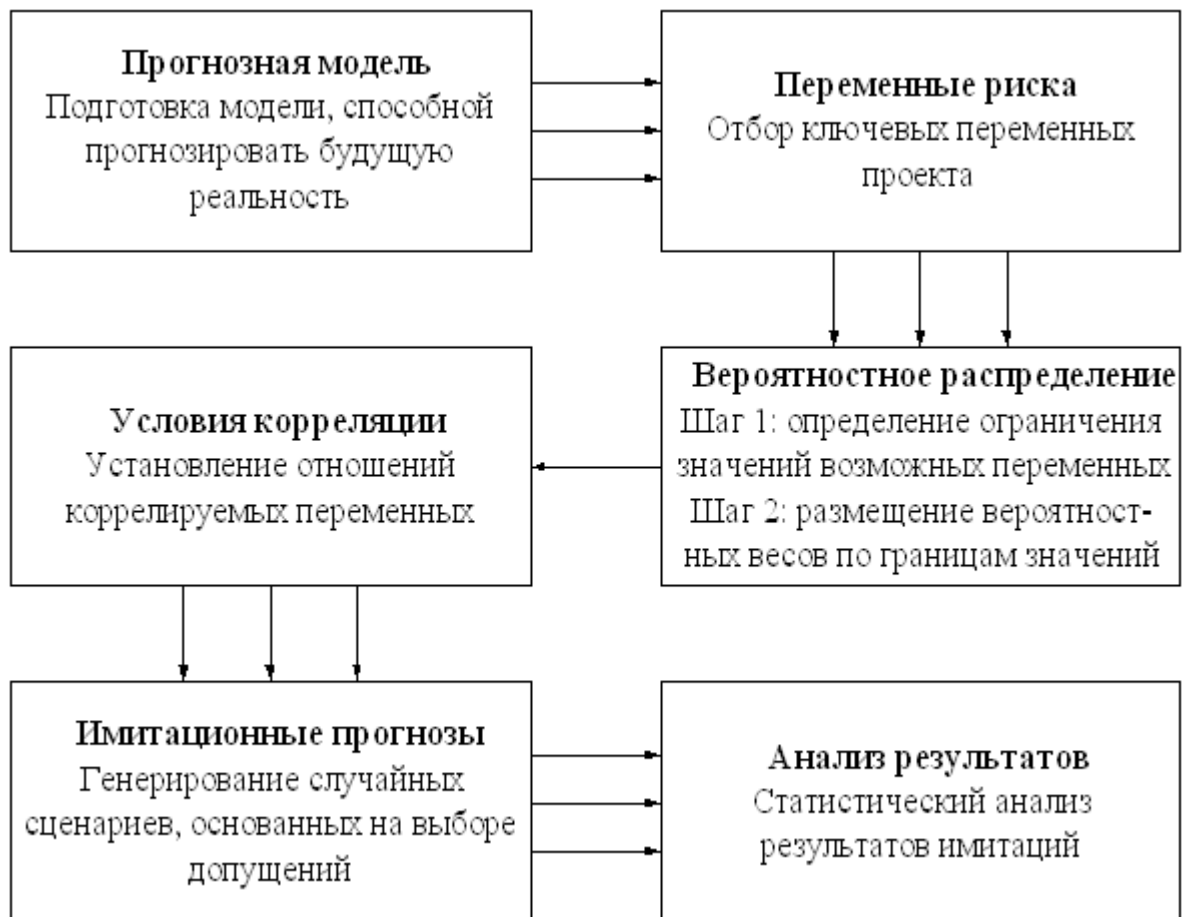
Рис.13. Блок-схема алгоритма имитационного моделирования по методу Монте-Карло
