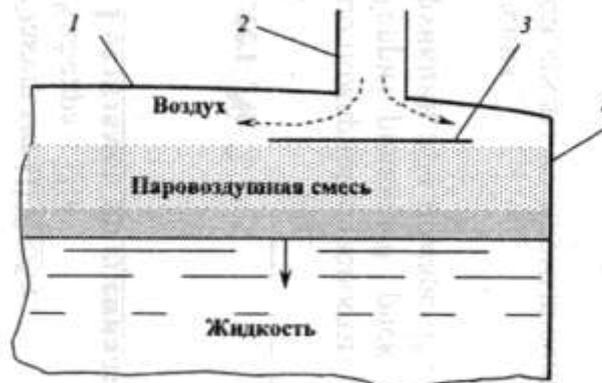
Рис. 2.8. Схема работы диска-отражателя при опорожнении резервуара:
