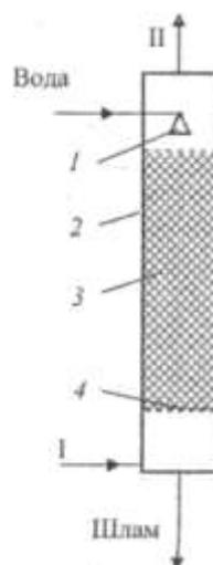
Рис. 6.2. Схема искрогасителя с орошаемой насадкой
