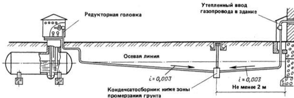
Рис.3.4. Схема газоснабжения сжиженным газом от резервуарной установки.
