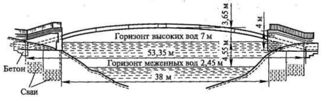
Рис. 2.4. Схема трубчатой арки.
