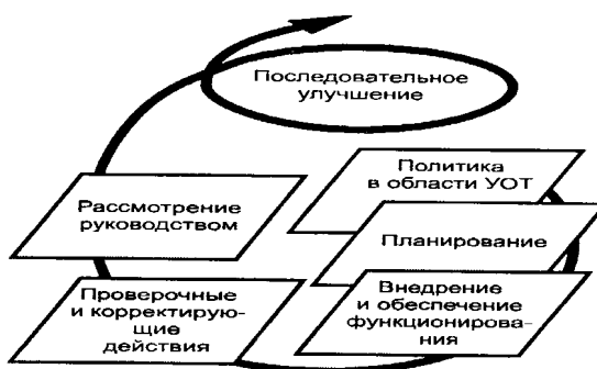
Рис.2.2. Модель системы управления охраной труда
