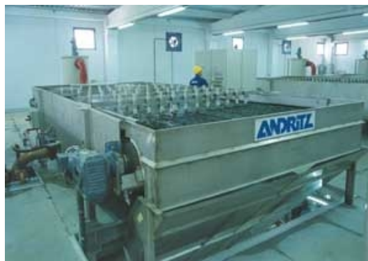
Рис. 5.4. Ленточный сгуститель производства Andritz (Австрия)
