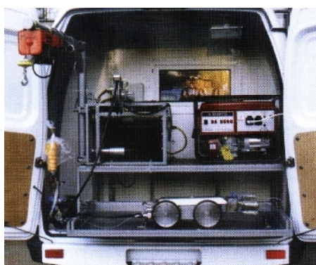
Рис. 2.15 Многофункциональный телевизионный комплекс Р-200 на автомобиле.
