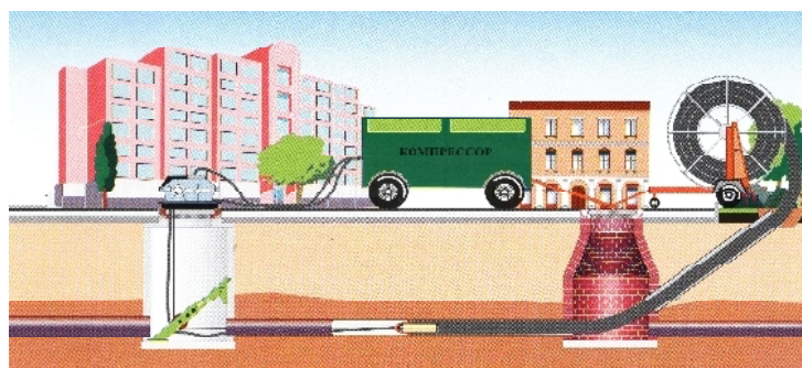
Рис. 2.3 Восстановление участка ветхой водопроводной сети без разрушения с помощью полимерных труб.
