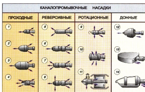
Рис. 2.20. Классификация и общий вид каналопромывочных насадок
