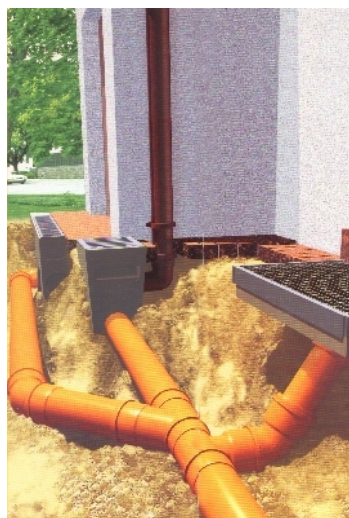
Рис. 4.17 Размещение дождеприемников около жилого дома
