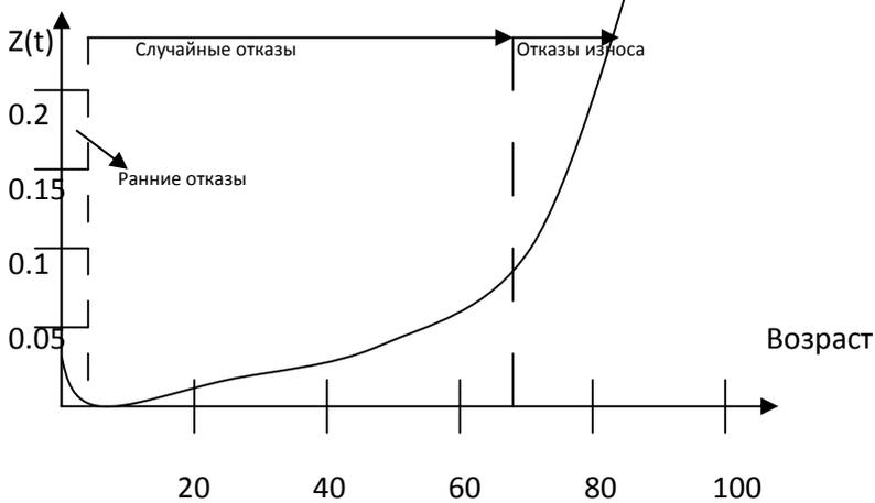
Рис.4 частота отказов  $r(t)$  в зависимости от  $t$ .
