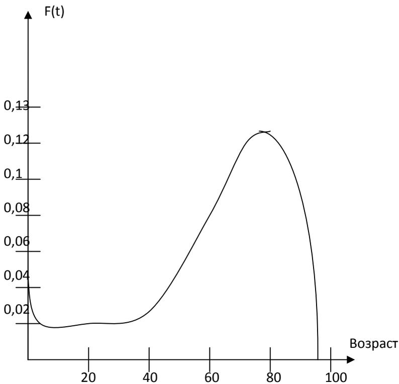
Рис.3. Плотность распределения отказов  $f(t)$
