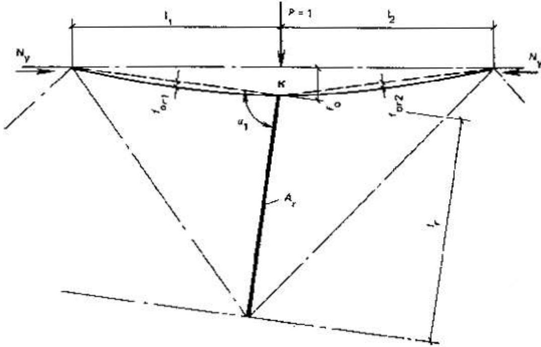
**Рис 22. Усиление сжатого элемента путем уменьшения расчетной длины**
