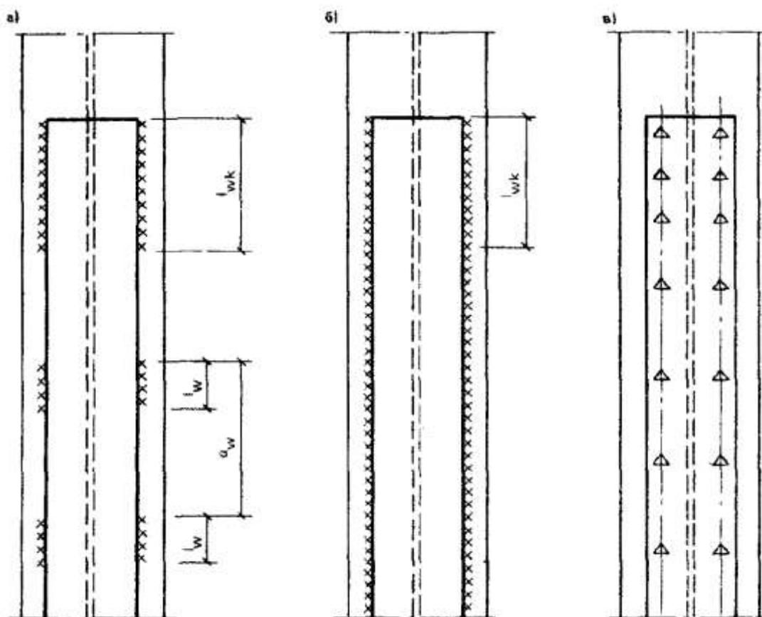
**Рис. 16. Присоединение элементов усиления**
