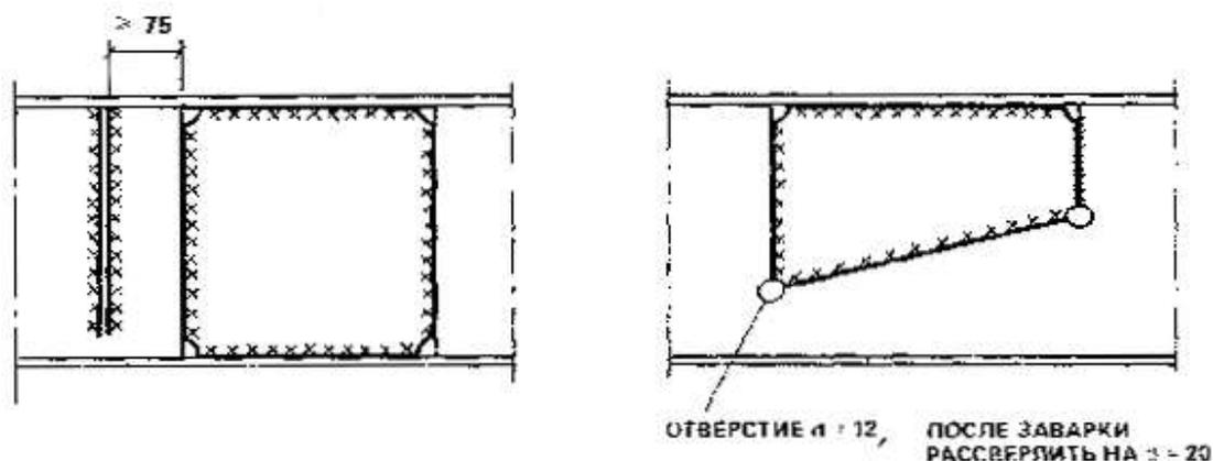
**Рис. 25. Конструктивные требования к взаимному расположению швов**
