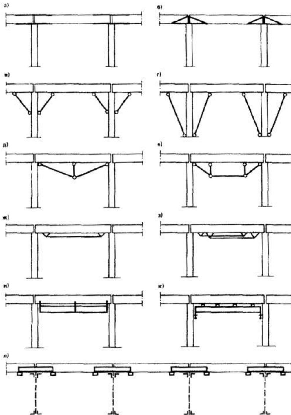
**Рис. 4. Усиление балок путем изменения их конструктивной схемы**
