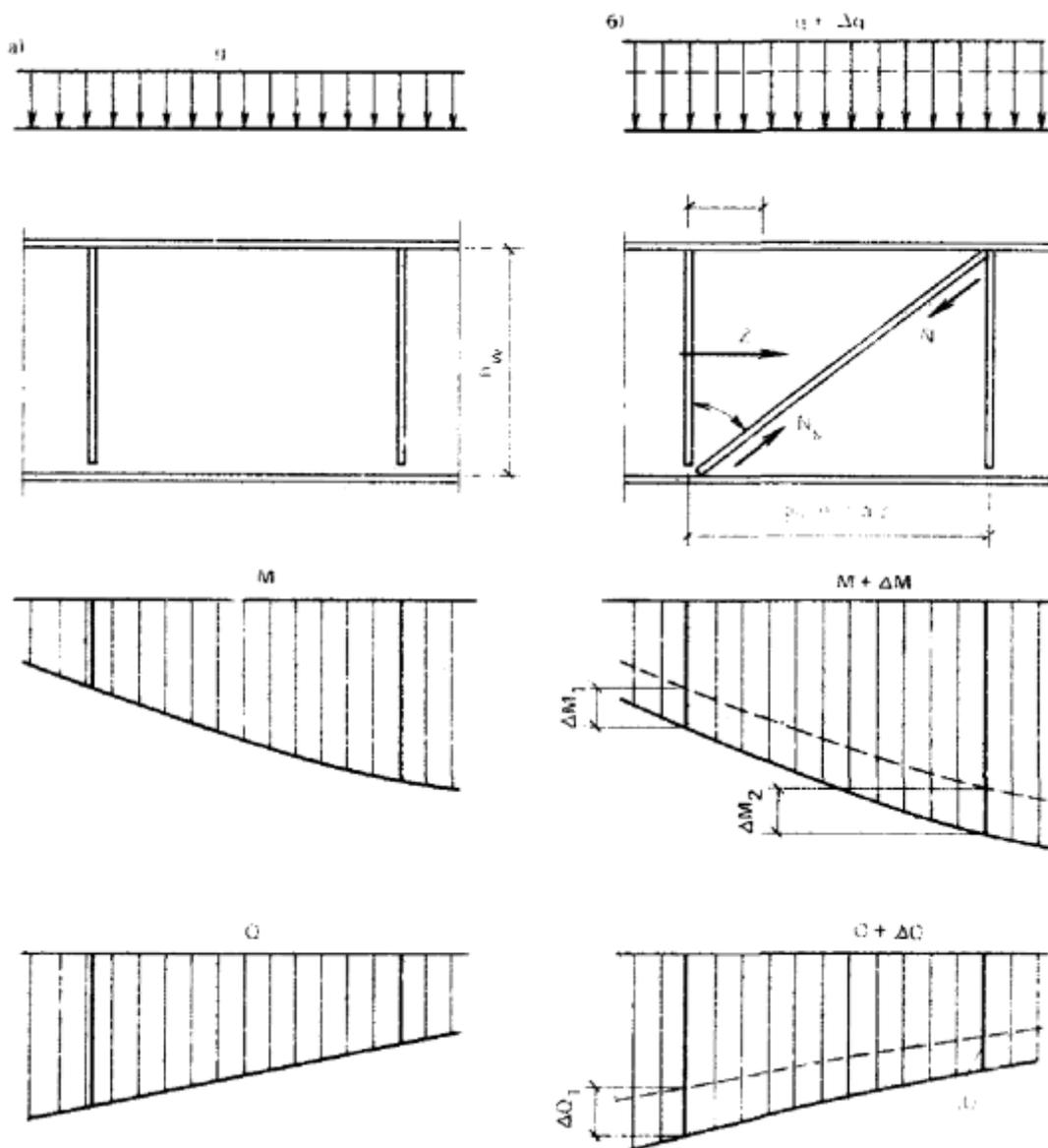
**Рис. 20. К расчету наклонных ребер**
