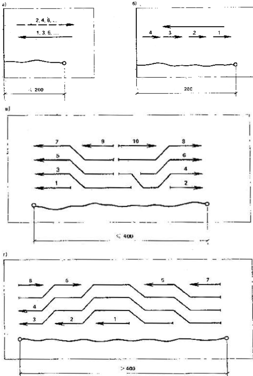
**Рис. 29. Последовательность заварки трещин**
