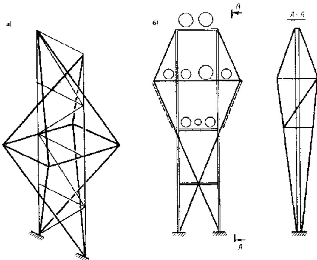
**Рис. 14.** Усиление плоских опор транспортных галерей и трубопровода путем уменьшения свободной длины поясов с помощью шпренгельных систем
