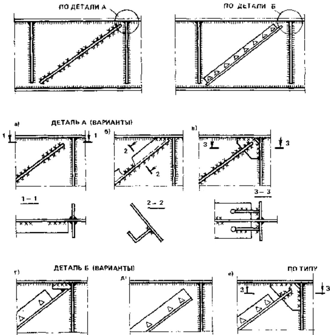
**Рис. 5. Установка наклонных ребер жесткости**
