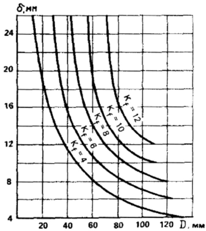
Рис. 24. Зависимость  $D$  от  $\sigma$  и  $k_f$
