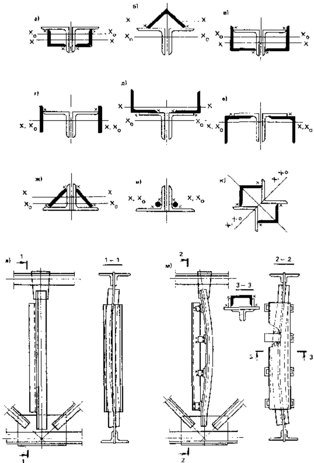
Рис. 7. Усиление элементов стропильных ферм
