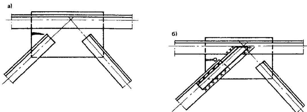
**Рис. 27. Установка «энергетического мостика» для предотвращения распространения трещины**
