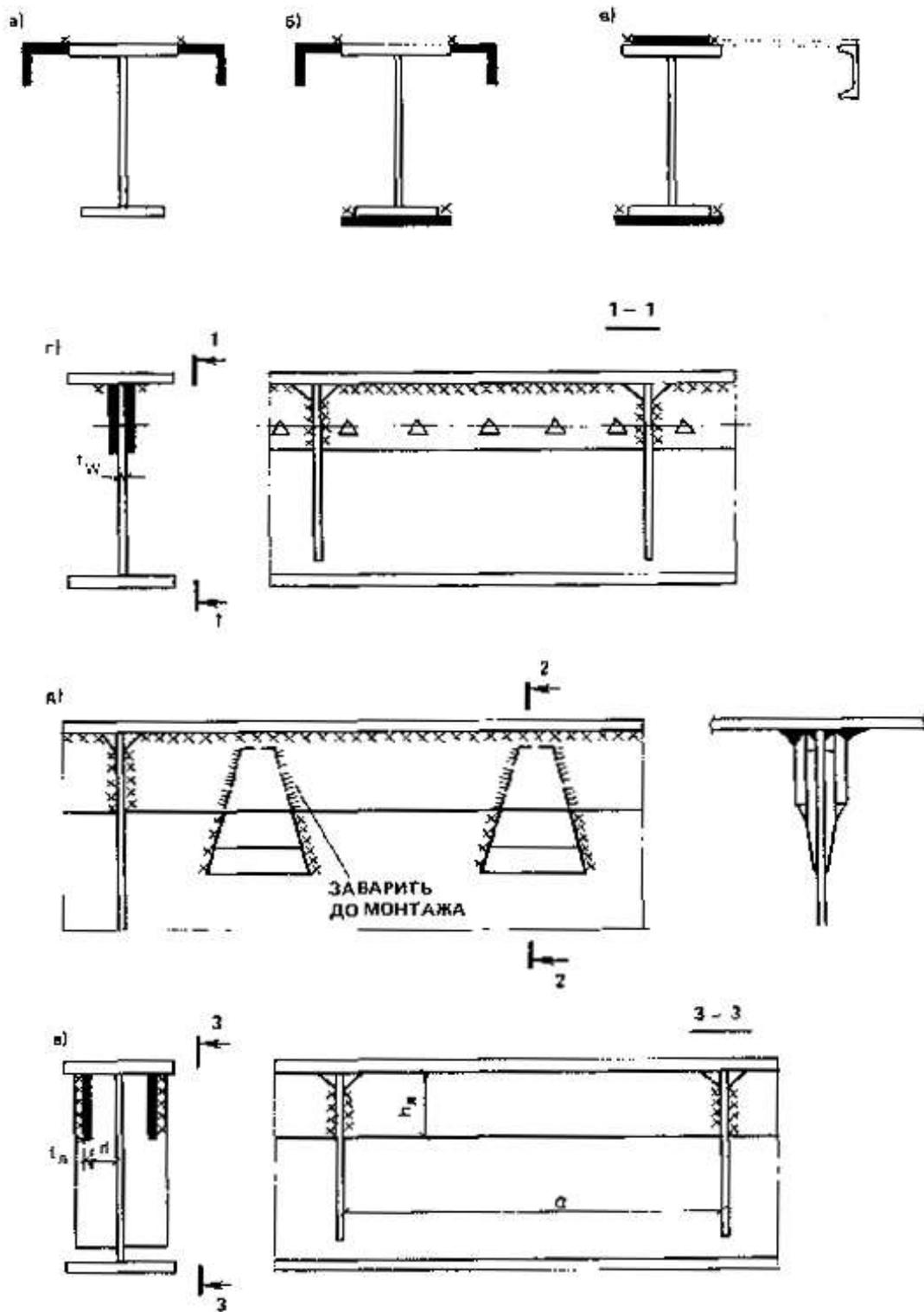
**Рис. 6. Усиление подкрановых балок**
