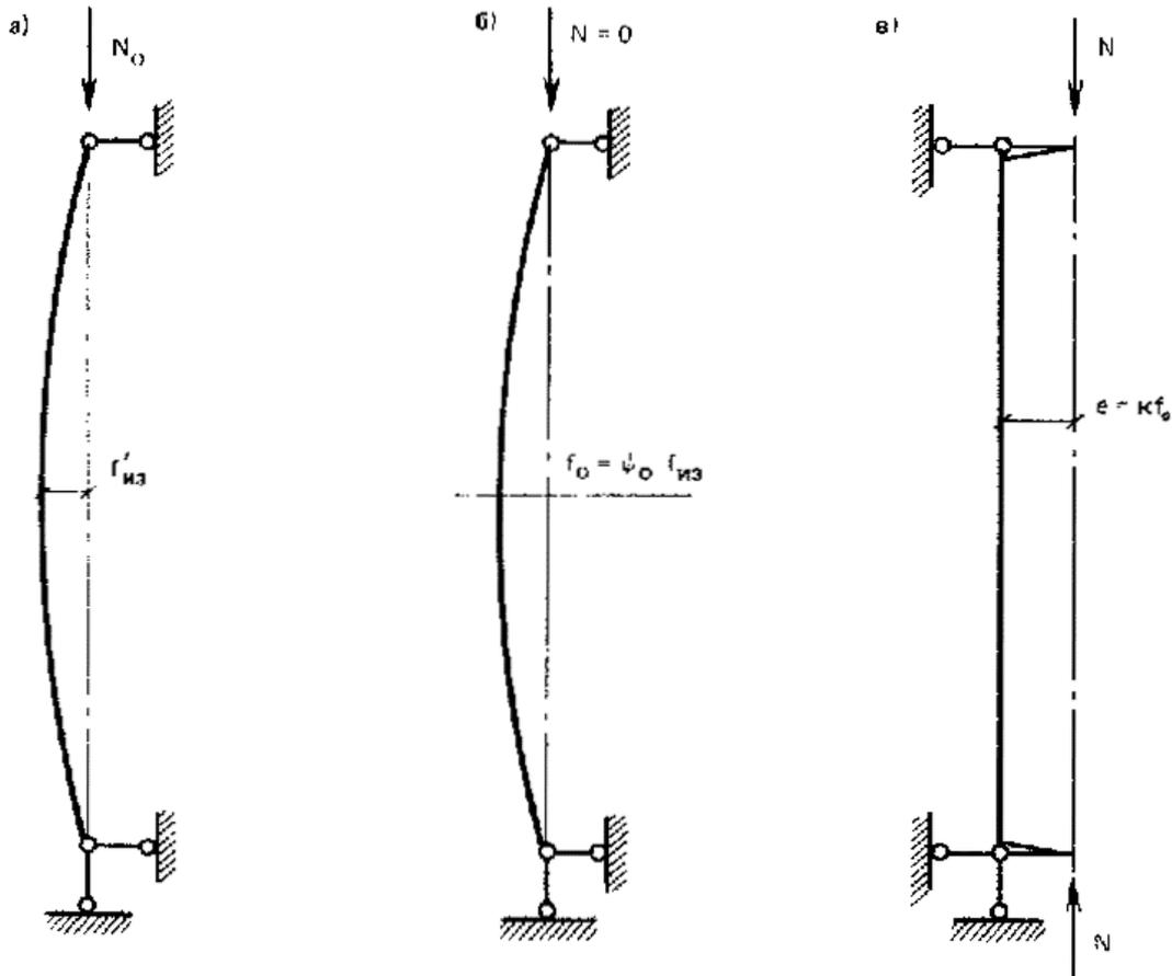
Рис. 1. Сжатый стержень с общим искривлением
