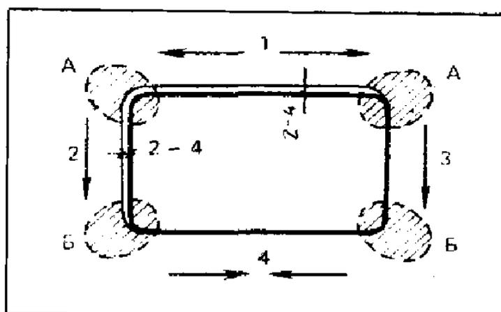
Рис. 32. Участки подогрева и последовательность сварки и вставки
