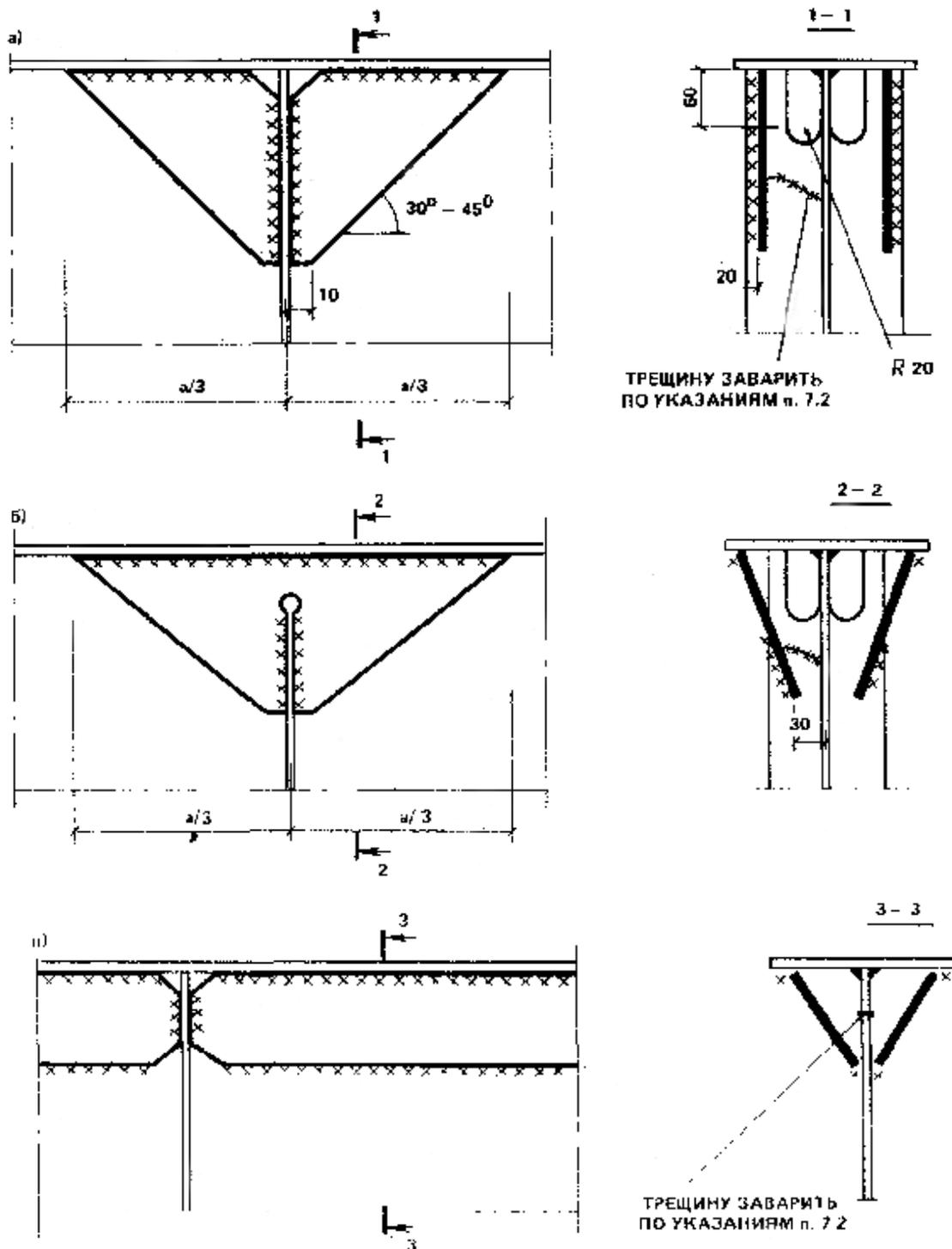
**Рис. 30. Усиление верхней зоны подкрановых балок**
