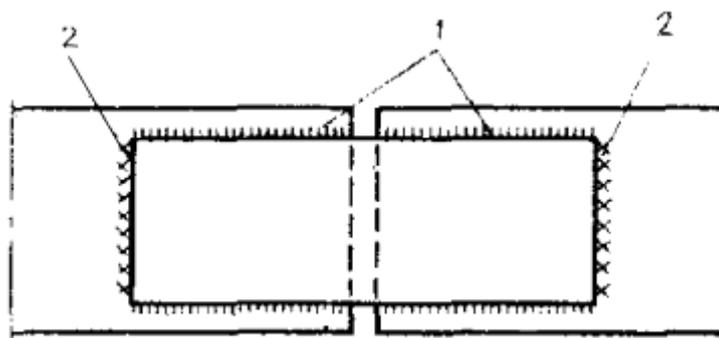
**Рис. 23. Усиление сварного соединения доваркой лобовых швов**
