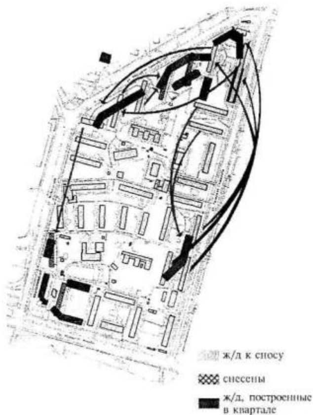
Рис. 14.1. Реконструкция квартала застройки методом последовательного сноса жилого фонда и нового строительства (Москва, Хорошево-Мневники)
