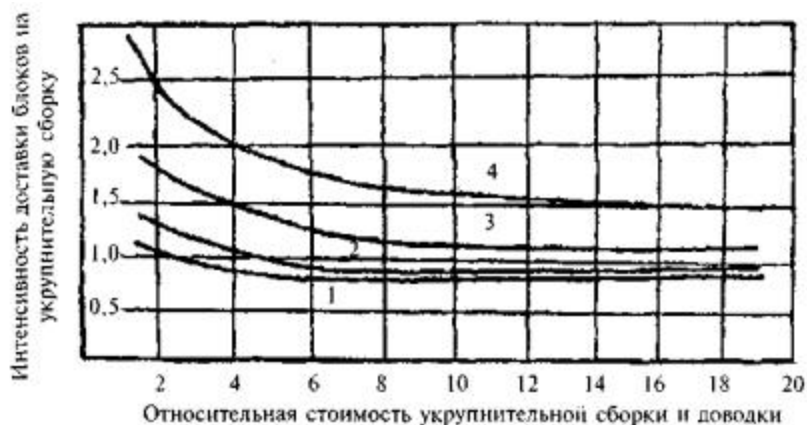
Рис. 10.50. Оптимальные интенсивности укрупнительной сборки и доводки блоков 1-4 при C_3 = (0,1; 0,2; 0,3; 0,4)C_1 , где C_1 - стоимость укрупнительной сборки; C_2 - стоимость простоя монтажного крана; C_3 - стоимость возврата блоков
