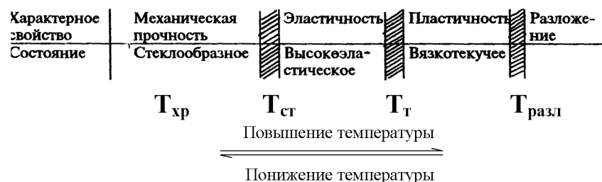
Рис. 2. Изменение состояния аморфных линейных полимеров при изменении температуры, T_{\text{хр}} – температура хрупкости; T_{\text{ст}} – температура стеклования, T_{\text{т}} – температура текучести, T_{\text{разл}} – температура разложения.
