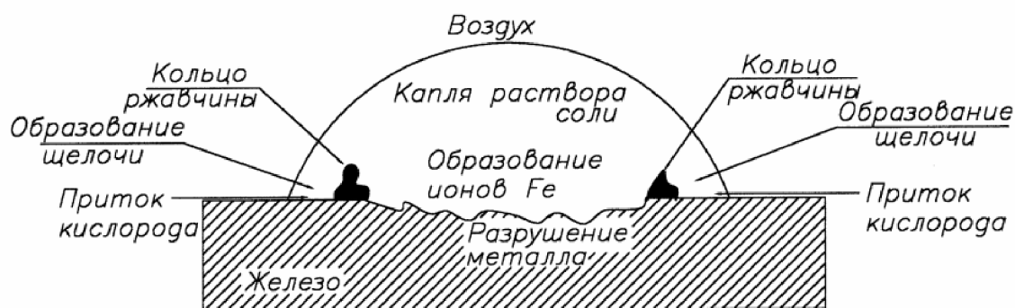
Рис. 6. Коррозия железа в условиях неравномерной аэрации
