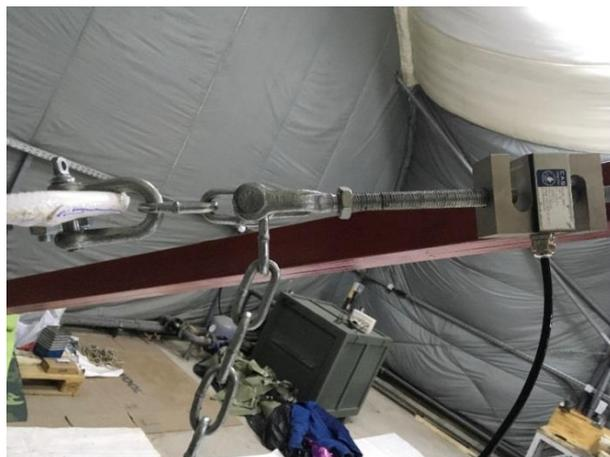
Рисунок 15. Общий вид положения датчика силы CAS SBA-1
