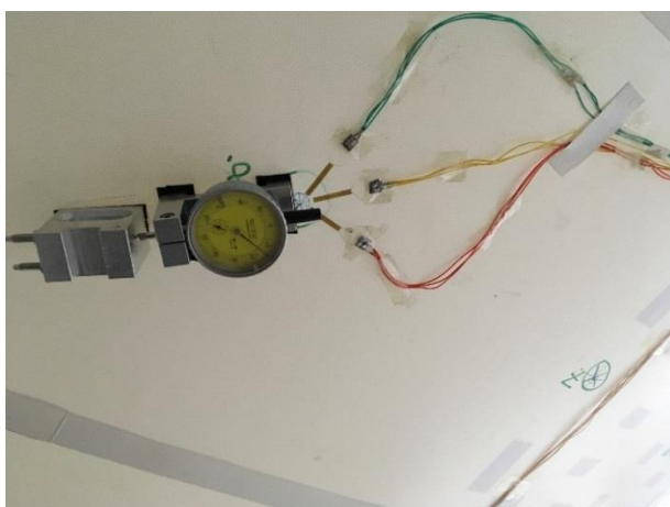
Рисунок 14. Тензорозетка и контроль деформаций тензорезисторов с помо-
