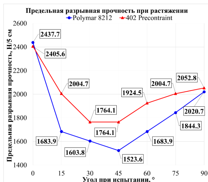
Рисунок 5. Предельная разрывная прочность технических тканей с покрытием при одноосном осевом и внеосевом растяжении
