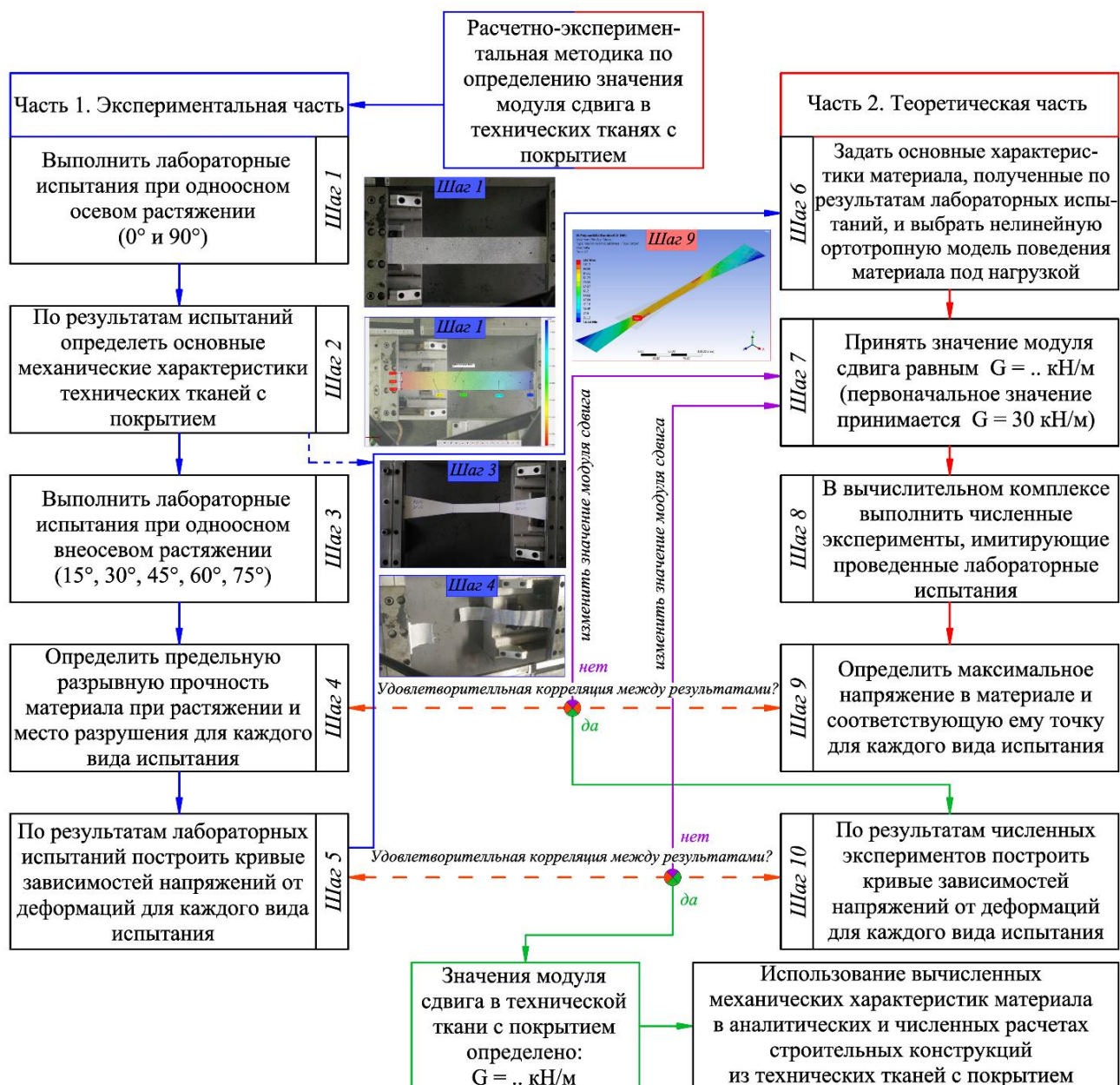
Рисунок 9. Блок-схема расчетно-экспериментальной методики по определению значения модуля сдвига в технических тканях с покрытием
