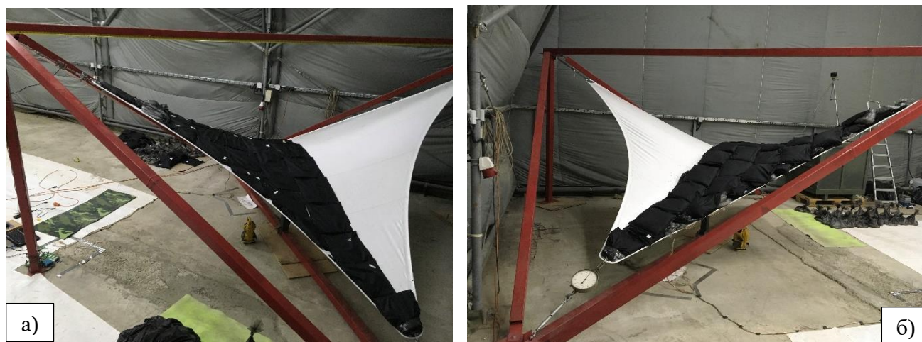
Рисунок 16. Схема приложения нагрузки на конструкцию в эксперименте:
