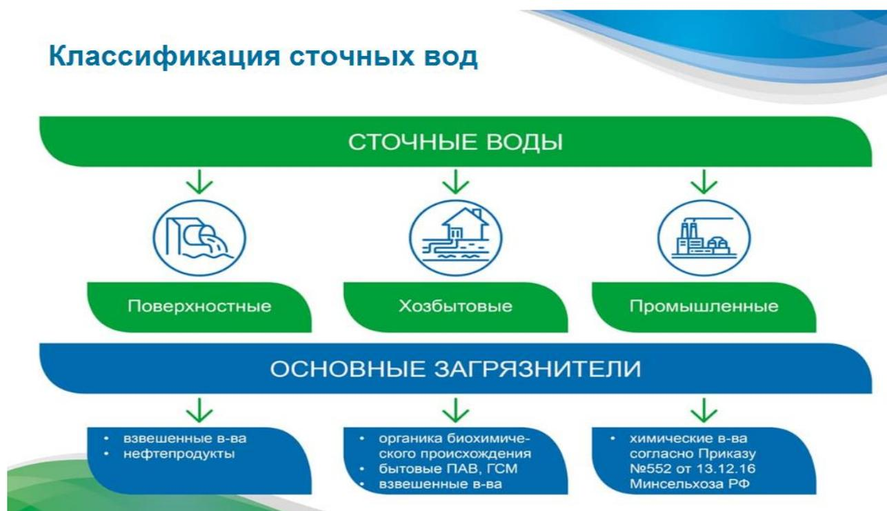
Рис. 38. Классификация сточных вод
