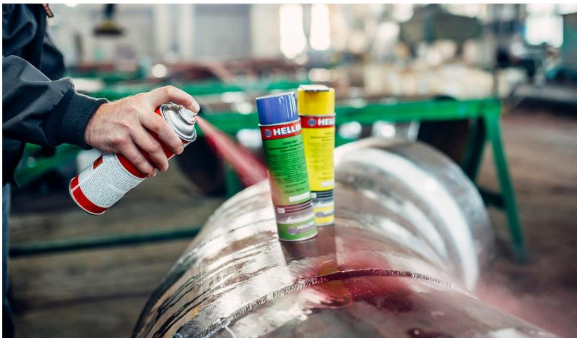
*Рисунок 8.4 – Нанесение пенетранта на сварной шов*
