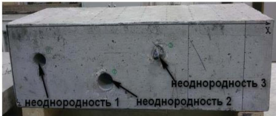
Рисунок 5.8 – Наглядный образец бетонной конструкции с имитацией различных видов дефектов-неоднородностей. Неоднородность 1 – сквозное цилиндрическое отверстие. Неоднородность 2- несквозное цилиндрическое отверстие. Неоднородность 3- арматура.
