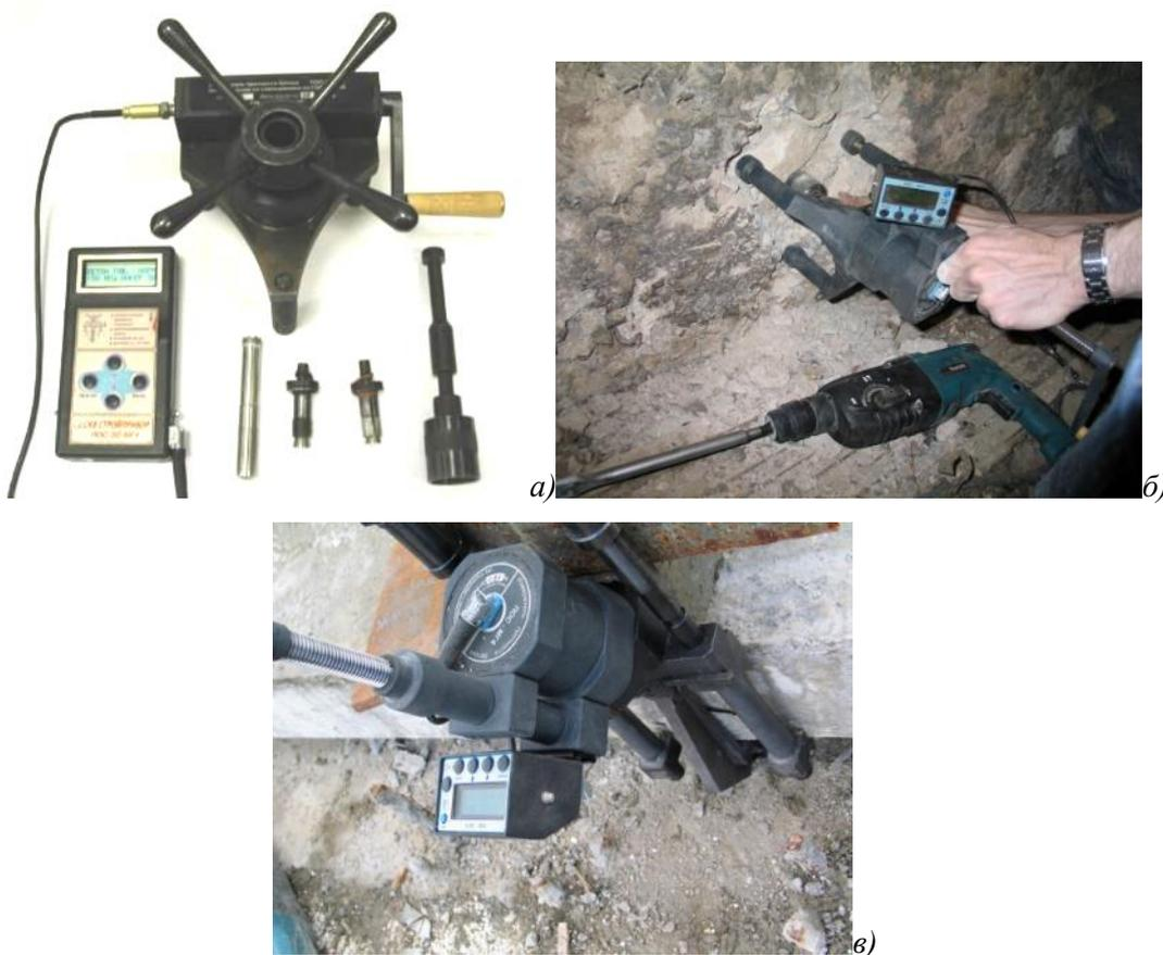
Рисунок 0.3 – Прибор «ПОС» а) общий вид б) проведение испытания методом «отрыв со скалыванием» в) проведение испытания методом «скалывания ребра»
