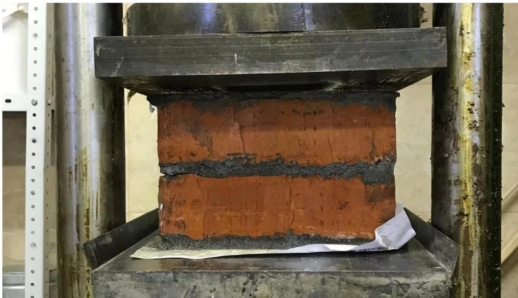
*Рисунок 0.21 – Испытание кирпича на сжатие на прессе*
