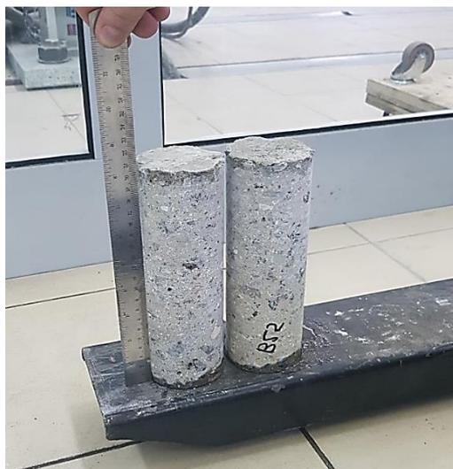
*Рисунок 0.17-Керны для изготовления образцов цилиндров*
