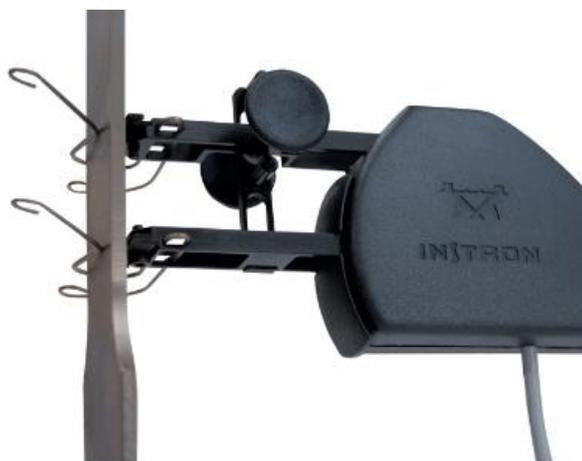
Рисунок 0.26 – Экстензометр Instron серии 2630
