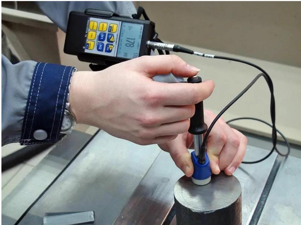
*Рисунок 0.9 – Применение динамического ударного твердомера*
