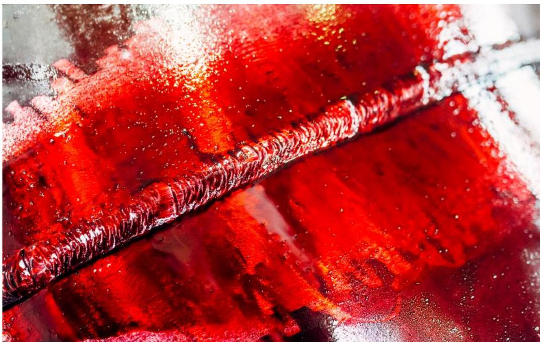
*Рисунок 8.5 – Проявление дефектов в зоне сварного шва*
