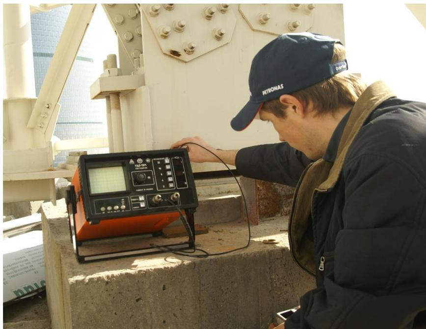
*Рисунок 5.11 – Ультразвуковой контроль сварных соединений*
