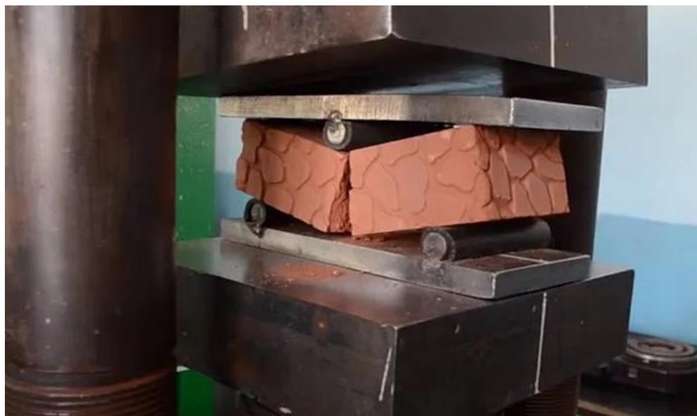
*Рисунок 0.22 – Испытание кирпича на изгиб на прессе*
