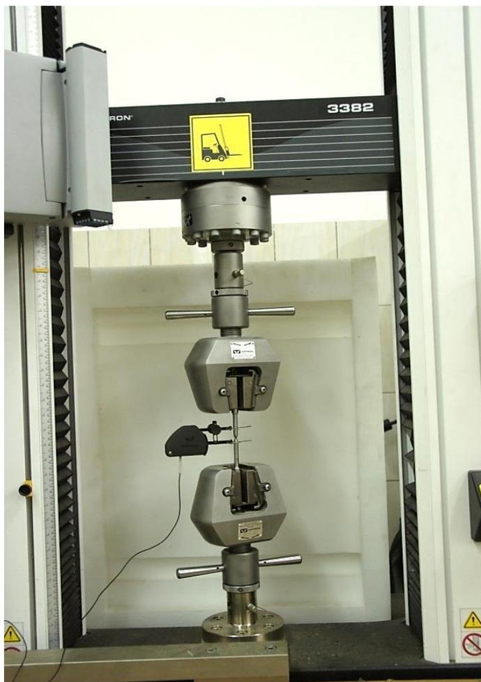
*Рисунок 0.24 – Оборудование для проведения испытаний на осевое растяжение металла*
