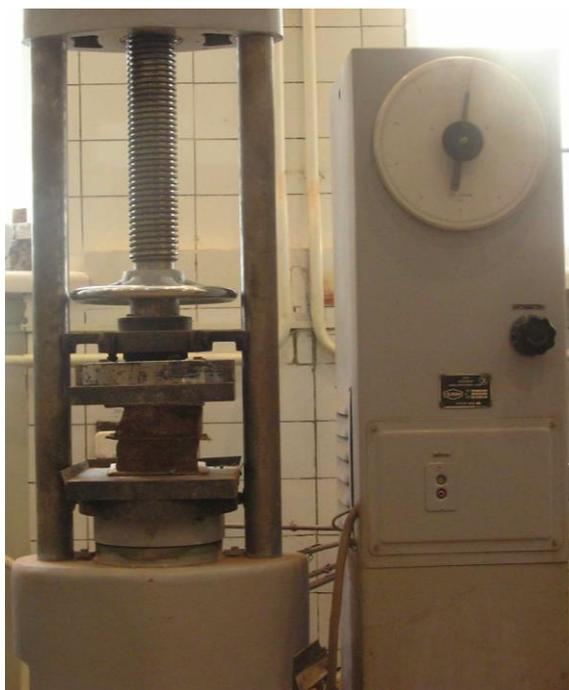
*Рисунок 0.11 – Испытание кирпича на сжатие*
