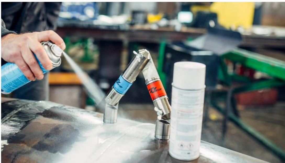
*Рисунок 6.4 – Нанесение магнитной суспензии на сварной шов*
