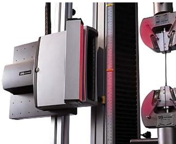
*Рисунок 0.27 – Общий вид оптического экстензометра Instron AVE 2663-821*
