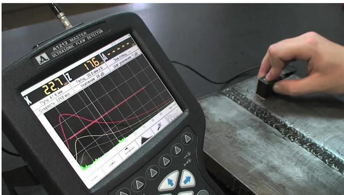
Рисунок 5.10 – Ультразвуковой контроль сварных соединений
