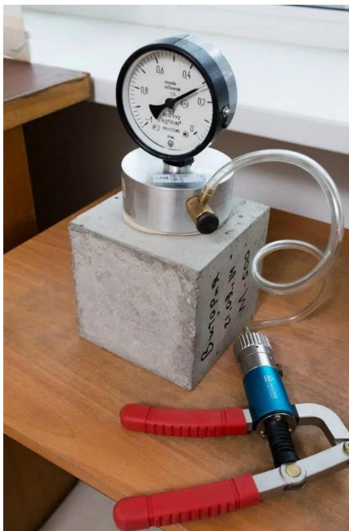
*Рисунок 8.6 – Прибор для определения водонепроницаемости бетона*
