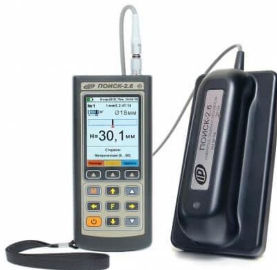
*Рисунок 6.7 – Измеритель толщины защитного слоя бетона*
