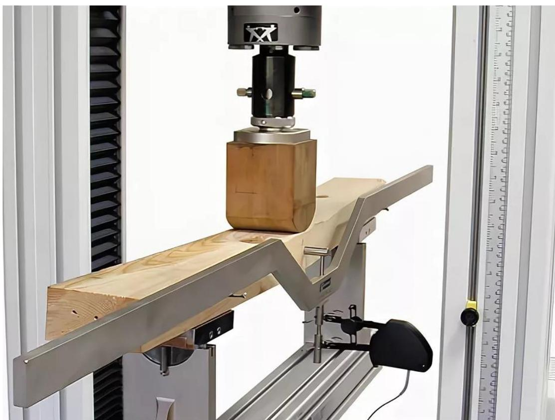
*Рисунок 0.28 – Оборудование для проведения испытаний древесины на изгиб*
