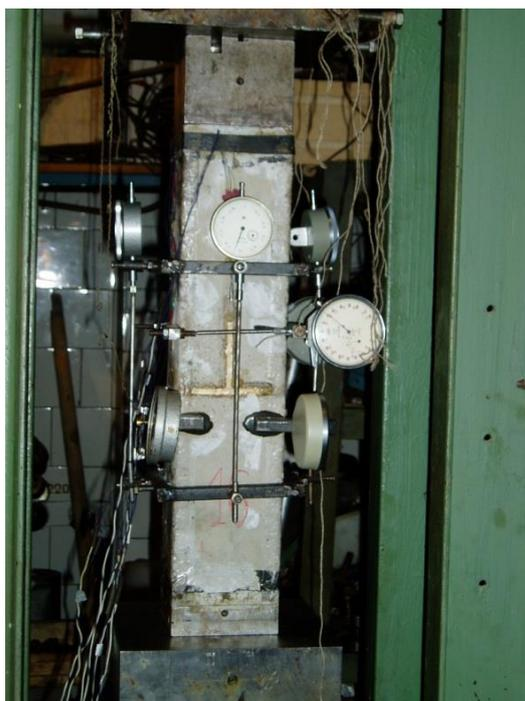
*Рисунок 0.12 – Испытание бетонной призмы на сжатие*
