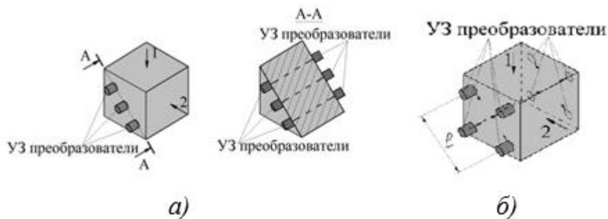
Рисунок 2.3 Схема испытания расположения излучателей и приемников - способом сквозного прозвучивания -а), способом поверхностного прозвучивания - б).
