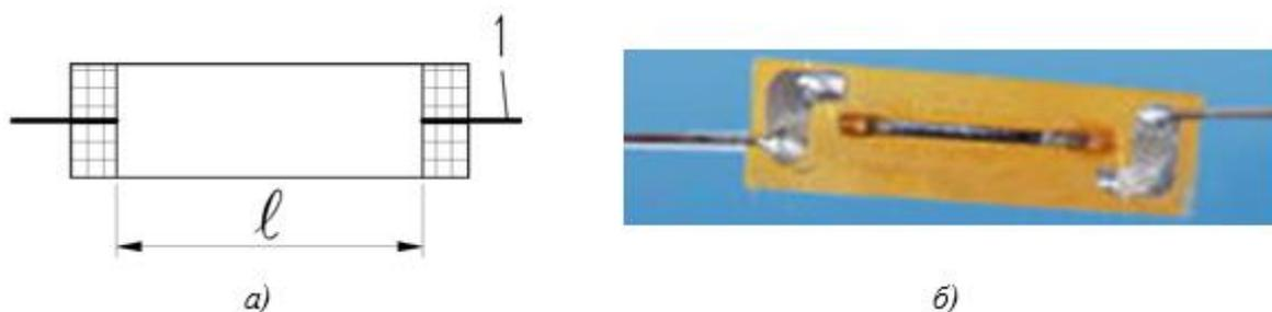
Рисунок 1.6 Схема (а) и общий вид (б) полупроводникового тензорезистора: 1 – контактные провода;  $l$  – база тензорезистора.
