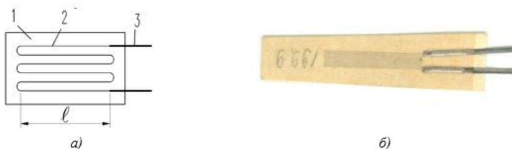
Рисунок 1.3 Схема (а) и общий вид (б) петлевого проволочного тензорезистора: 1 – основа тензорезистора; 2 – микропровод (тензочувствительный элемент); 3 – контактные провода (медные); l – база тензорезистора
