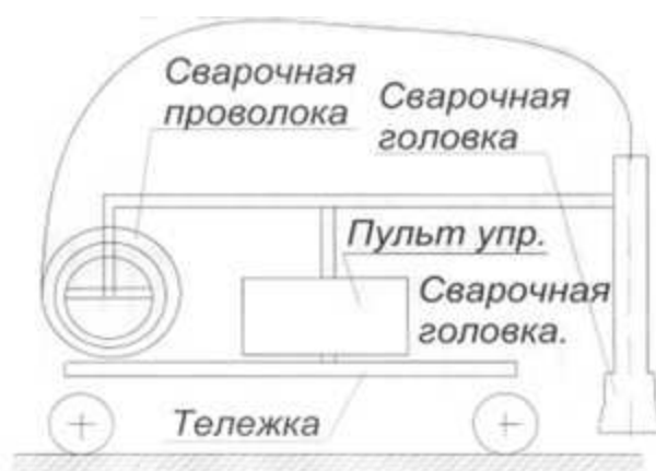
Рис.9-3. Общий вид сварочного трактора для сварки в среде углекислого газа
