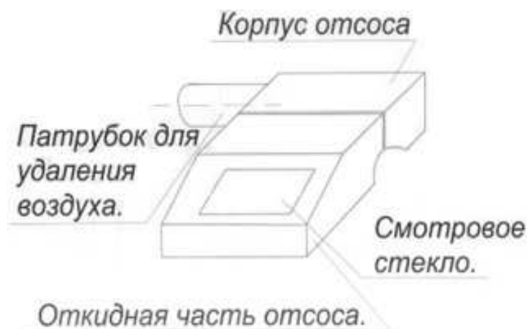
Рис.9-4. Схема укрытия установки для сварки встык
