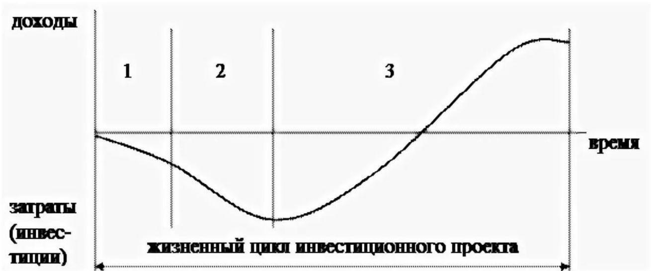
Рис.4. Жизненный цикл инвестиционно-строительного проекта в зависимости от баланса «затраты – доходы»
