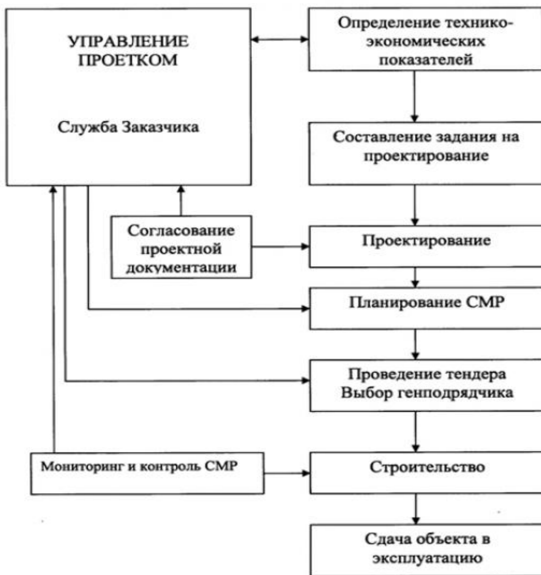
Рис.27. Позиционирование мониторинга в системе управления инвестиционно-строительными проектами
