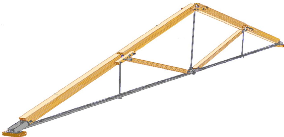
Рис. 5.3.1. Четырехпанельная ферма треугольного очертания
