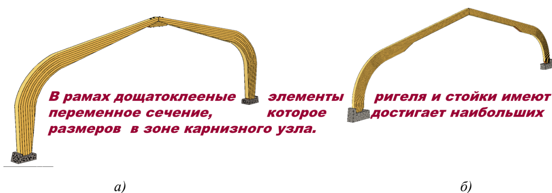
Рис. 4.11.1.1. Доштокклеенные гнутые рамы: а) - с переменной высотой сечения; б) - со ступенчатым изменением высоты сечения
