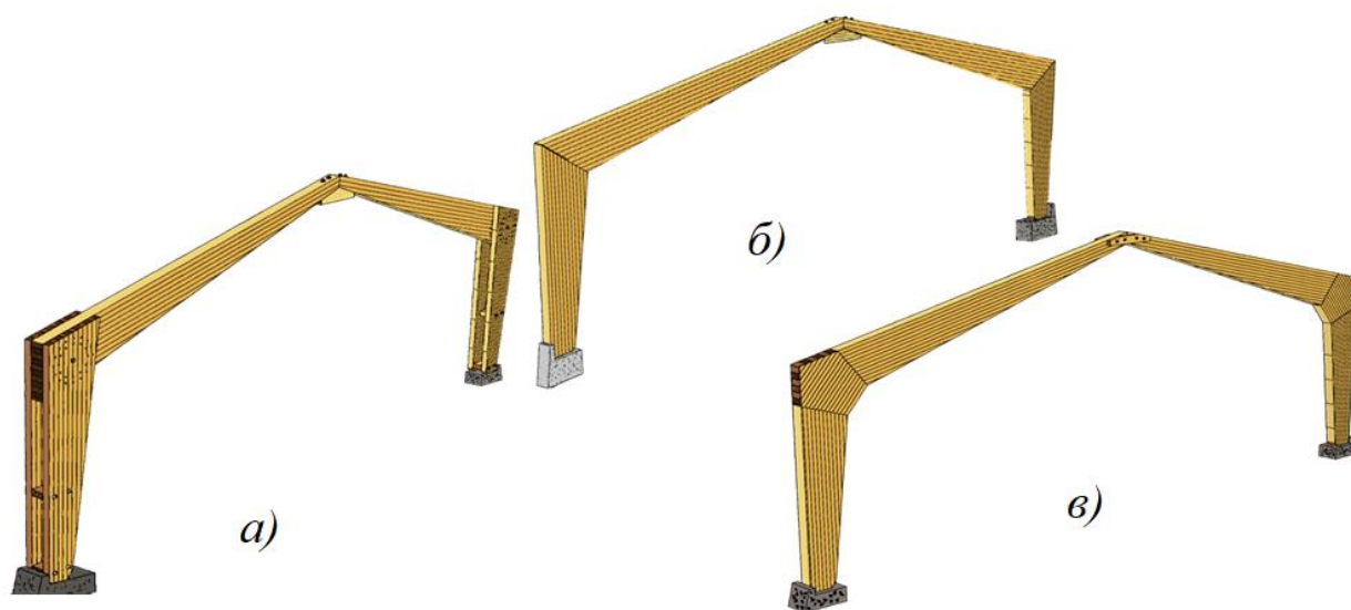
Рис. 4.13.2.1. Дощатоклеенные рамы из прямолинейных элементов а) - с соединением в карнизном узле на нагелях, б) - с карнизным узлом, соединенным на зубчатый шип, в) - с карнизным узлом из пятиугольной вставки
