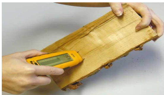
Рис. 1.10. Определение влажности с помощью электровлагомера
