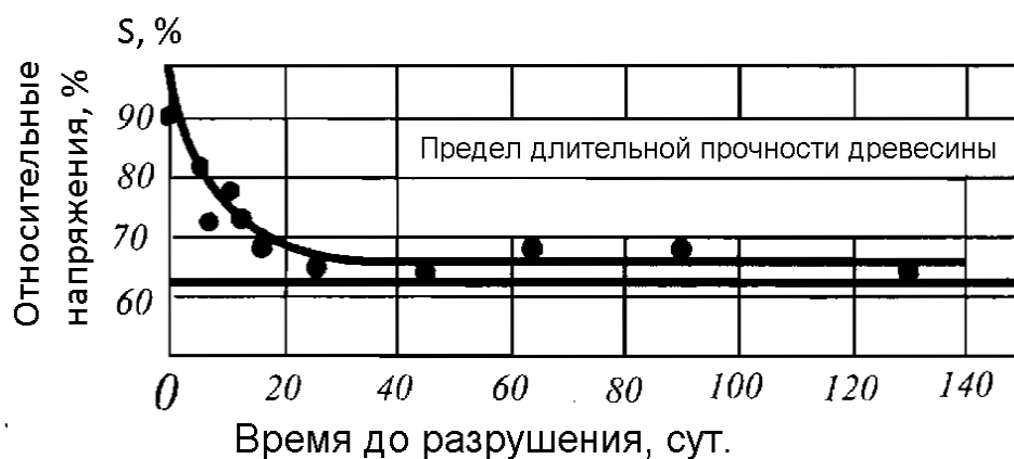
Рис. 1.8. Кривая длительной прочности древесины
