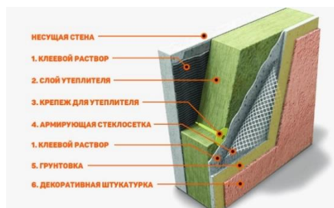
Рис. 2.10 Штукатурный фасад по утеплителю
