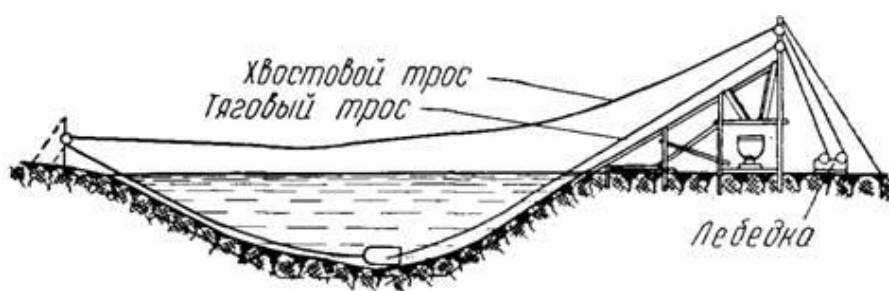
Рис. 2.11. Береговое устройство для протаскивания трубопровода
