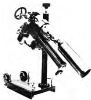
Рис. 4.3. Сверлильный станок с алмазно-кольцевым сверлом
