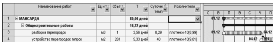
Рис. 6.6. График производства работ плотниками
