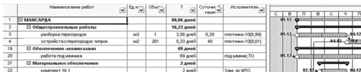
Рис. 6.5. График производства работ на неделю
