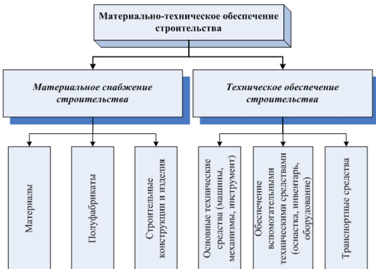
Рис. 1.1. Виды материально – технического обеспечения
