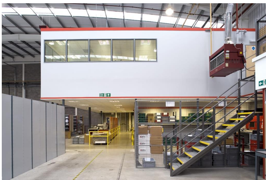
Рис 1. Пример выполнения встройки в одноэтажное промышленное здание.
