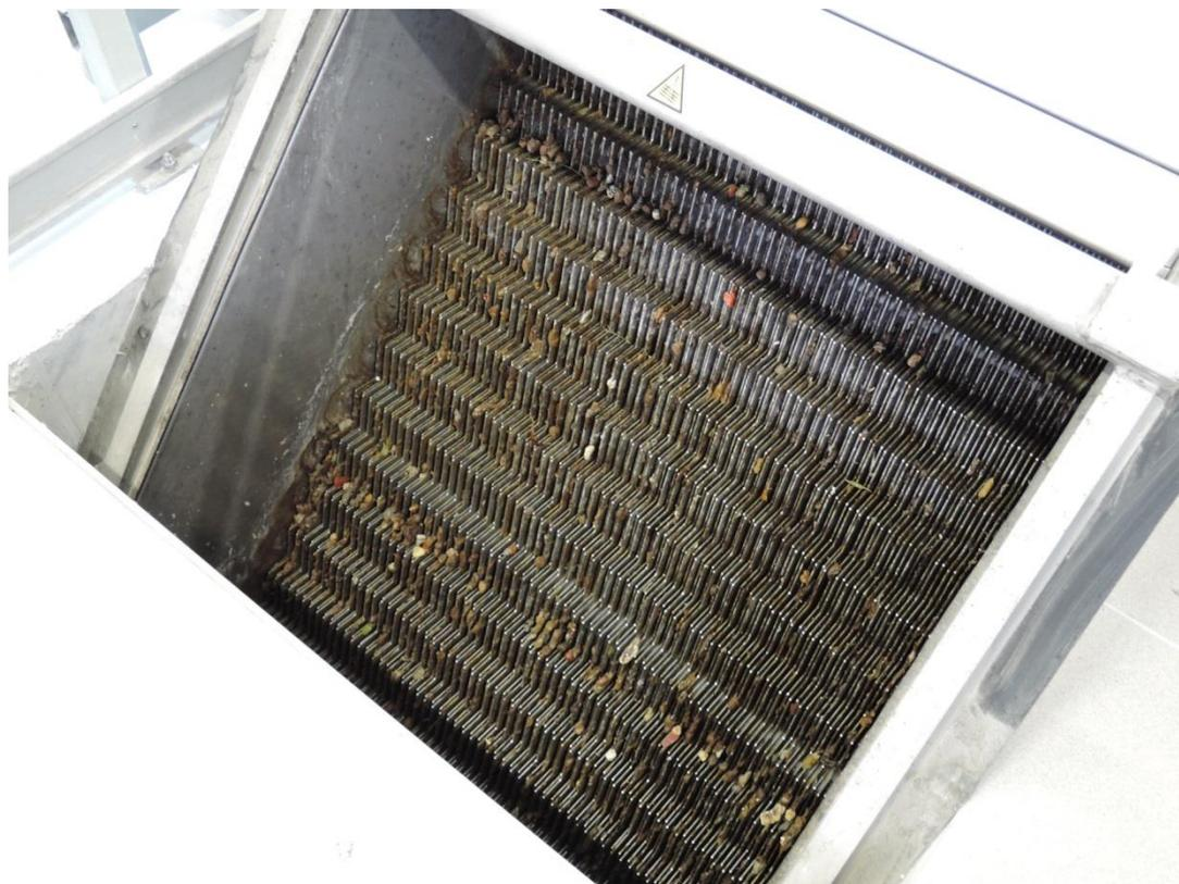
**Рис. 6.1.** Рабочее полотно механизированной ступенчатой решетки
