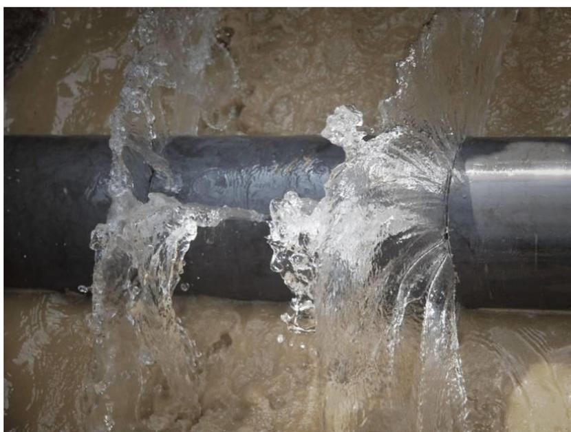
**Рис. 4.6.** Повреждение трубопровода (кольцевой перелом чугунной трубы).
