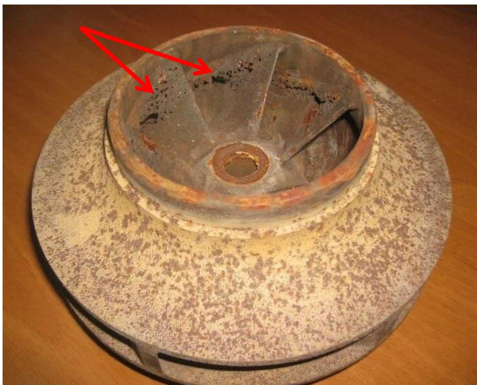
**Рис. 2.2.** Пример кавитационного износа лопаток рабочего колеса насоса
