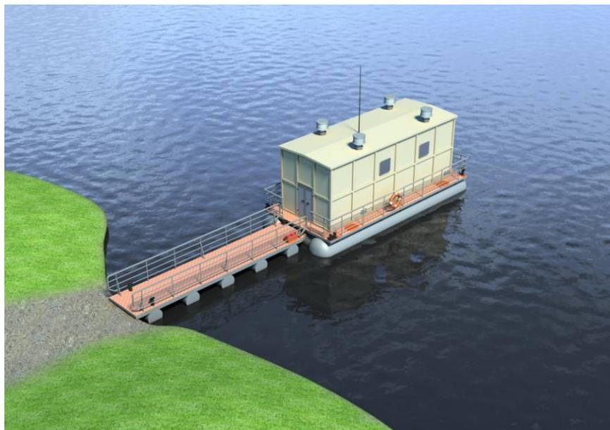
*Рис. 2.3. Водозаборное сооружение плавающего типа из поверхностного водоисточника*
