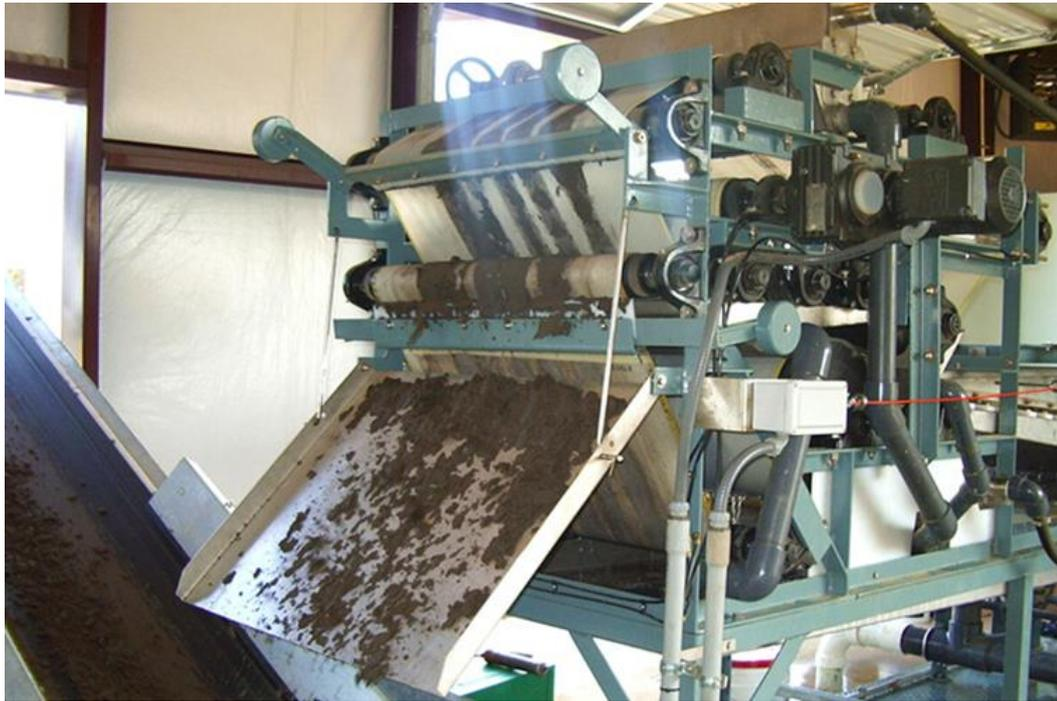
**Рис. 6.6.** Ленточный фильтр-пресс для обезвоживания осадка
