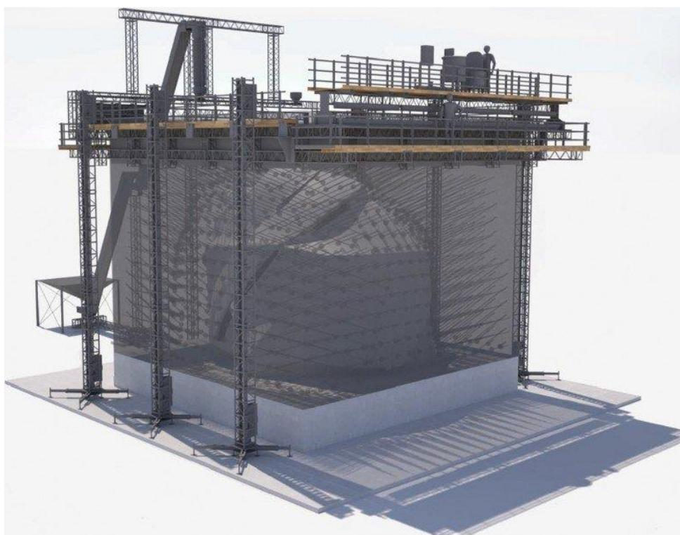
*Рис. 3.4. Строительный 3D-принтер D-Shape*
