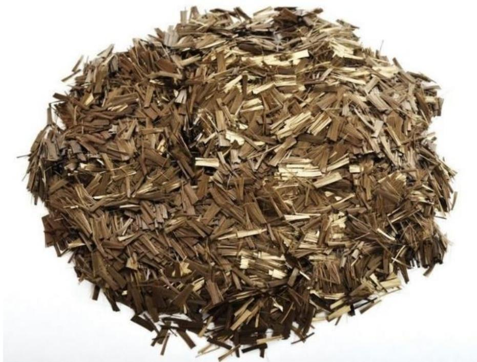
*Рис. 3.13. Фибра для дисперсного армирования*
