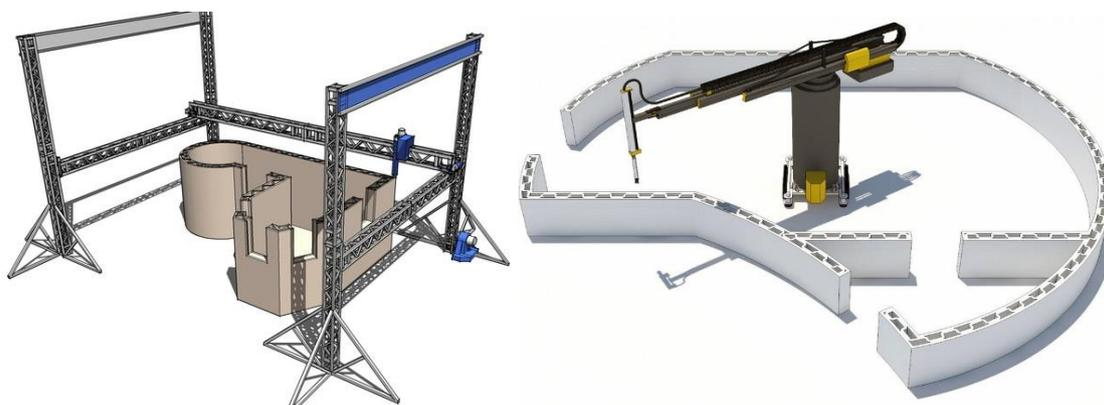
Рис. 4.7. Схемы установки 3D-принтера на строительной площадке относительно строящегося здания
