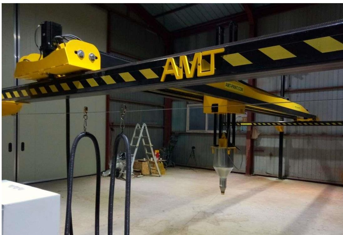
*Рис. 3.6. 3D-принтер «АМТ» для цехового производства*
