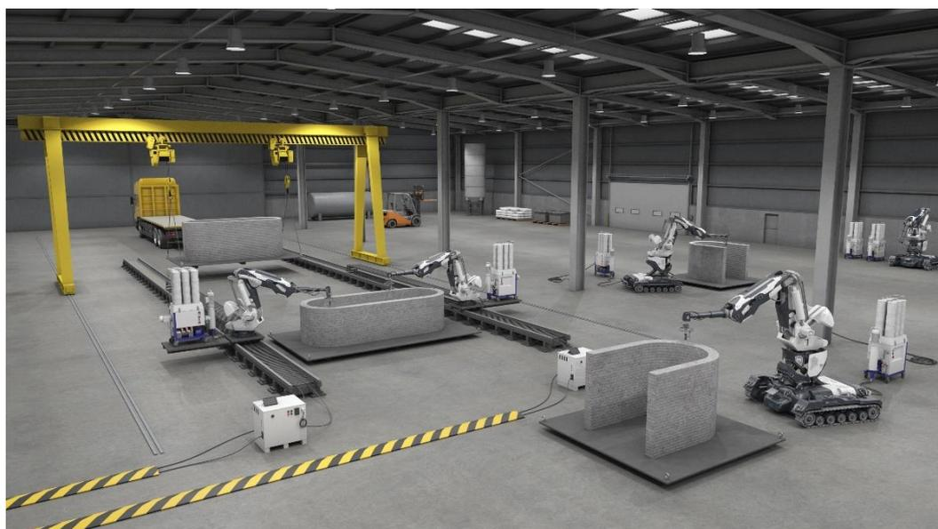
*Рис. 3.16. Процесс 3D-печати элементов строительных конструкций в заводских условиях*
