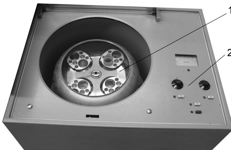
Рис. 1.4. Лабораторная центрифуга: 1 – ротор; 2 – блок управления.
