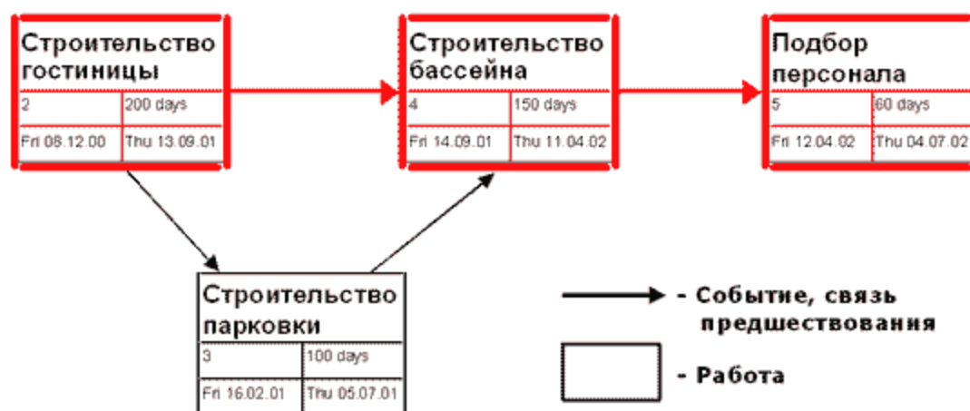
Рис. 4. Сетевая модель типа "Работа-вершина" - Сеть предшествования.
