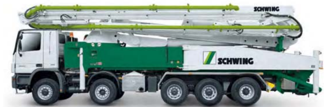
Рис.1. Автобетононасос SCHWING S36 SX
