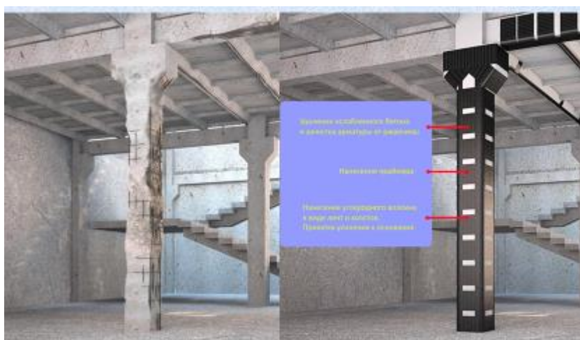
Рис. 5.14 Усиление колонны углеродными полосами
