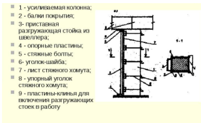
Рис. 5.3 усиление колонны установкой разгружающих стоек
