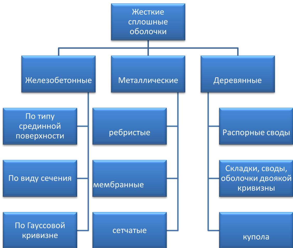
Рис. 3 Классификация жестких сплошных оболочек
