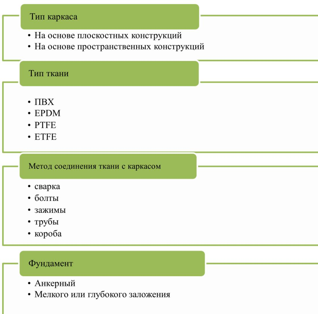
Рис. 9. Классификация тентовых конструкций
