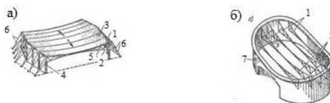
*Рис. 3. Покрытия с параллельно расположенными тросовыми фермами системы инженера Д.*
