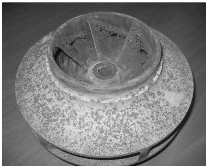
Рис. 1.2. Разрушение лопастного насоса из-за процесса кавитации
