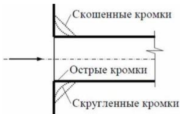
Рис. 2.22 Потери давления при входе в трубу
