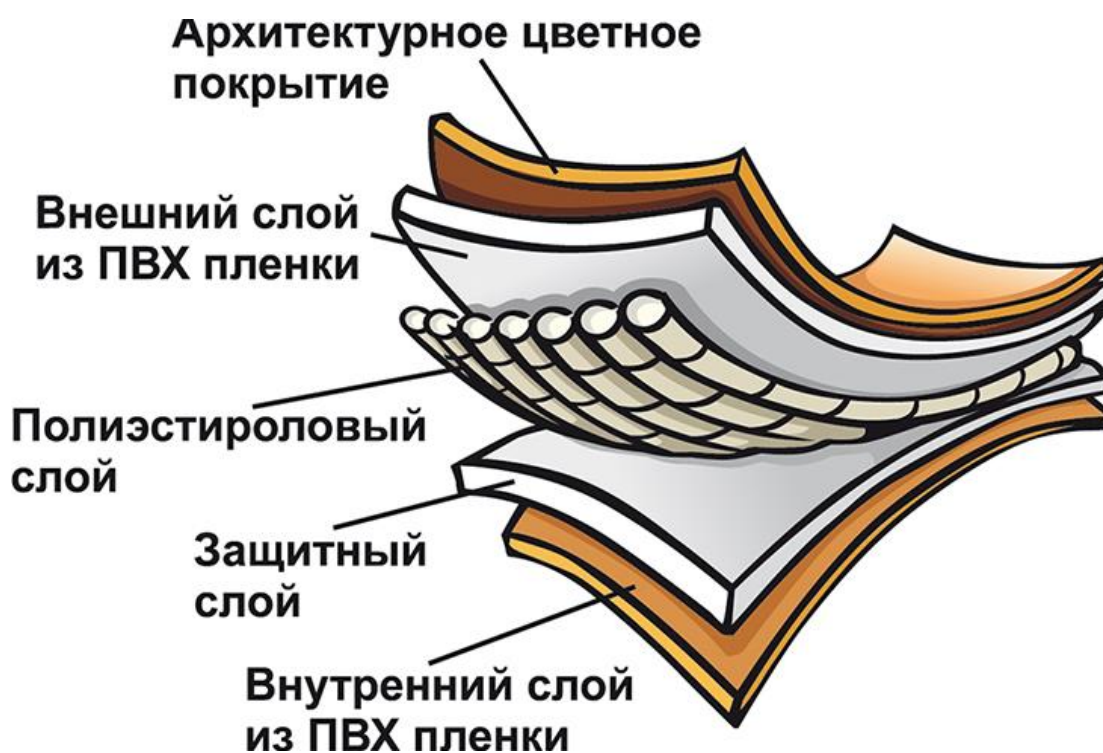
Рис. 8. Структура материала для пневматических конструкций
