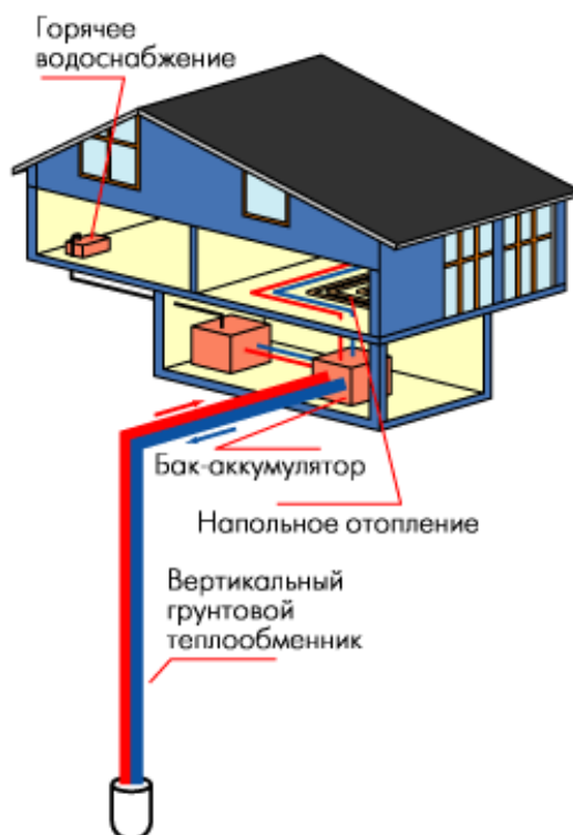
Рис. 9. Схема отопления и горячего водоснабжения одноквартирного жилого дома посредством теплонасосной установки с вертикальным грунтовым теплообменником
