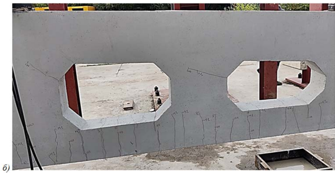
Рисунок 12.1. Состояние Образца №1 на момент окончания испытания P_{test.1} = 200.8 кН а) общий вид образца б) трещинообразование в нижнем поясе
