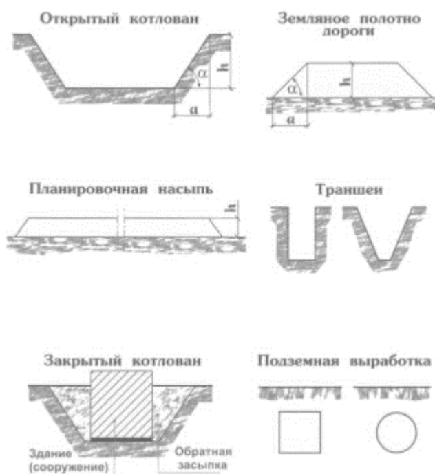
Рис. 2.3.1. Наиболее характерные типы земляных сооружений
