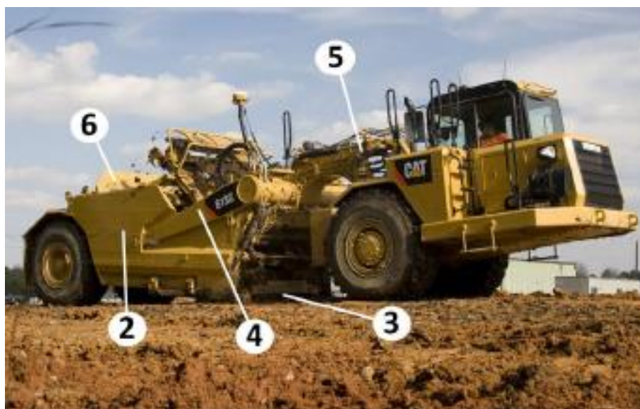
Рис. 2.13.3. Принципиальная схема скрепера: 1 – силовая установка - одноосный трактор; 2 – ковш; 3 – двухлезвийный нож; 4 – П-образная рама; 5 – хобот; 6 – выдвижная задняя стенка ковша для принудительной разгрузки.
