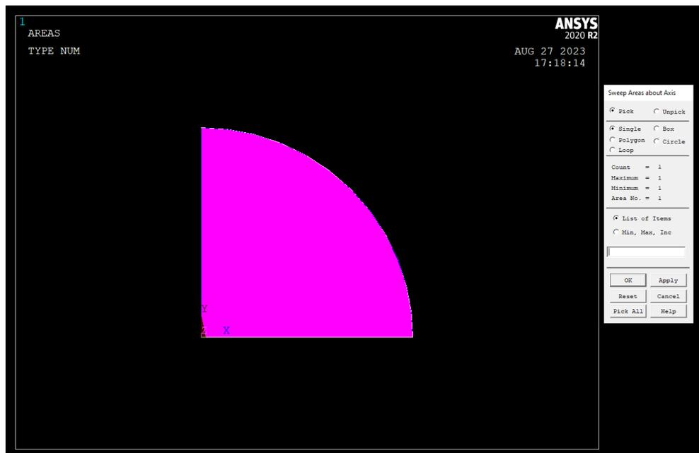
*Рис.12. Выбор поверхности для выдавливания вокруг оси ZX*
